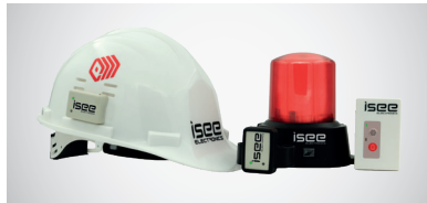
UWB Tabanlı ACTINSAFE Çarpışma Önleyici Sistem
